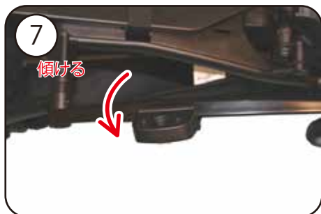
⑦アダプター<B>は、外側に傾けるように力を加えると取り外せます。
