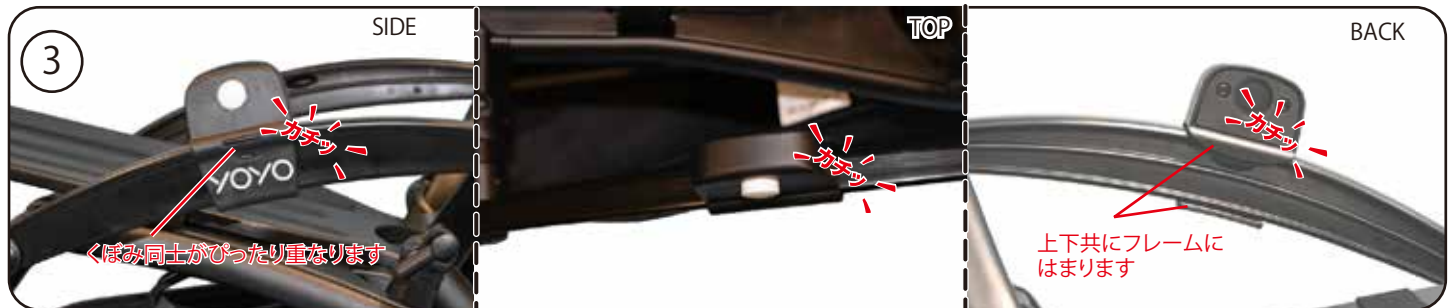
③アダプター<B>の「YOYO」ロゴとフレームの「YOYO」ロゴが重なるとカチッとはまります。必ずガタつきやゆるみがないか、確実にハマっているか確認してください。
