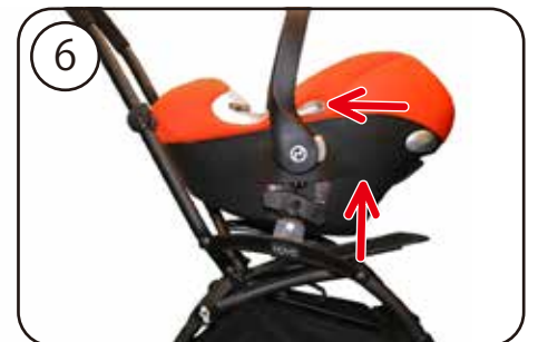
⑥インファントシート(ベビーシート)は左右の取外しボタンを押すと、アダプター<A>と一緒に取り外す事ができます。車に取り付ける際は必ずアダプター<A>をインファントシート(ベビーシート)から取り外してください。 ※アダプター<A>を取り外す際はお手持ちのインファントシート(ベビーシート)に付属の取り扱い説明書に従ってください。
